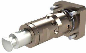
Das Herz der Elektropumpe TWIN-PUMP 2 besteht aus der Pumpgruppe TWIN, in der die beiden Elemente untergebracht sind, die abwechselnd von den zentralen Nocken angetrieben werden und das Schmiermittel ansaugen und abgeben.
