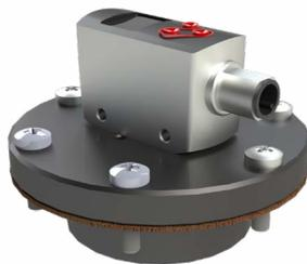
Sie messen den Abstand von der Oberfläche des Schmierstoffs im Inneren des Behälters. Sie bieten eine hohe Genauigkeit und die Messung hängt von der Fettkonsistenz ab. Das Schmiermittel-Reservesignal wird gesendet, wenn sich noch 10 kg Fett im 100-kg-Tank und 3 kg im 30-kg-Tank befinden.
