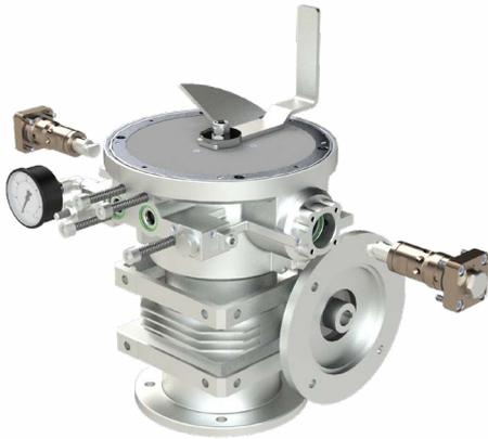
Die abwechselnde Bewegung der beiden Kolben gewährleistet einen konstanten und gleichmäßigen Schmiermittelfluss, das Erreichen von hohen Druckwerten (400 bar) und die Möglichkeit, mit der Arbeit fortzufahren, wenn eines der beiden Pumpelemente ausfällt.
