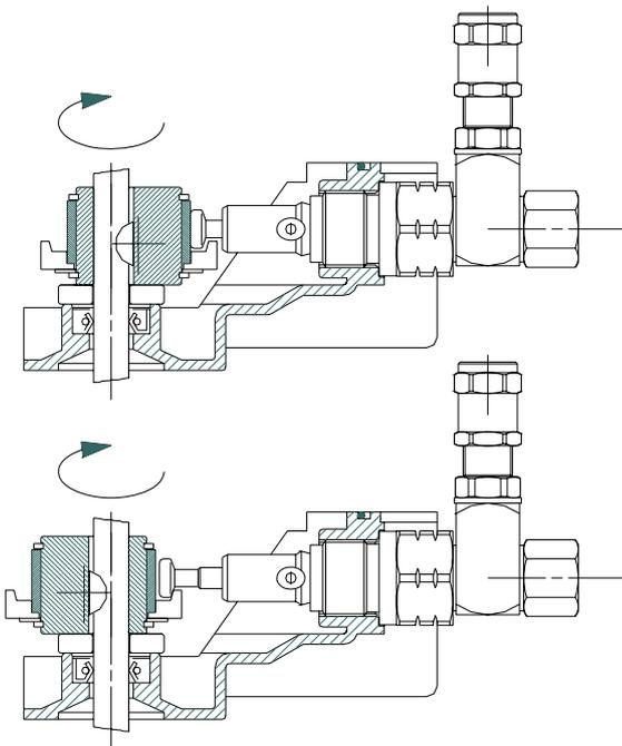
Die PEG-Pumpen sind für Aussetz- oder Dauerbetrieb ausgelegt. Anhand einer externen SPS können Schmierzyklen in Abhängigkeit der Anwendungen programmiert werden.
