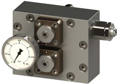
Das Herz der Elektropumpe TWIN-PUMP besteht aus der Pumpgruppe TWIN, in der die beiden Elemente untergebracht sind, die abwechselnd von den zentralen Nocken angetrieben werden und das Schmiermittel ansaugen und abgeben.
