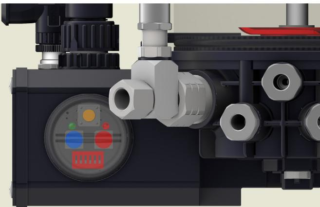
Der Timer der Pumpe **MINI-MAX** befindet sich in der Struktur in der Nähe des Getriebemotors und ist zugänglich durch Entfernen der durchsichtigen Schutzkappe. Dank der Durchsichtigkeit können die beiden Led-Anzeigen, die die eingeschaltete Spannung und den Niveaularm anzeigen, von außen kontrolliert werden; nach dem Entfernen des Schutzes können die Zeiten und die Funktionen in der gewünschten Modalität eingestellt und der Handtaster aktiviert werden.
