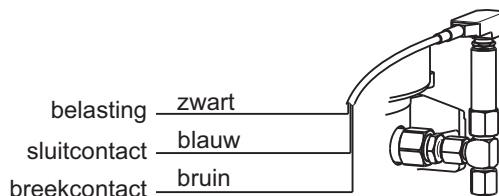
Aansluitschema voor de aansluiting van de microschakelaar op een externe besturing
