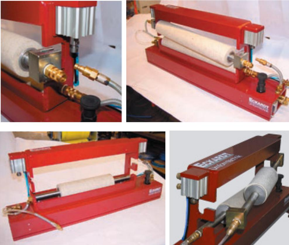
Un lubrificateur (type de base) permet de changer de divers largeurs de bandes en quelques secondes. Ce système est utilisé quand on rencontre des limitations (suivant la règle de 60% : les largeurs minimales/maximales) ou quand un changement d'huile rapide est exigé.
