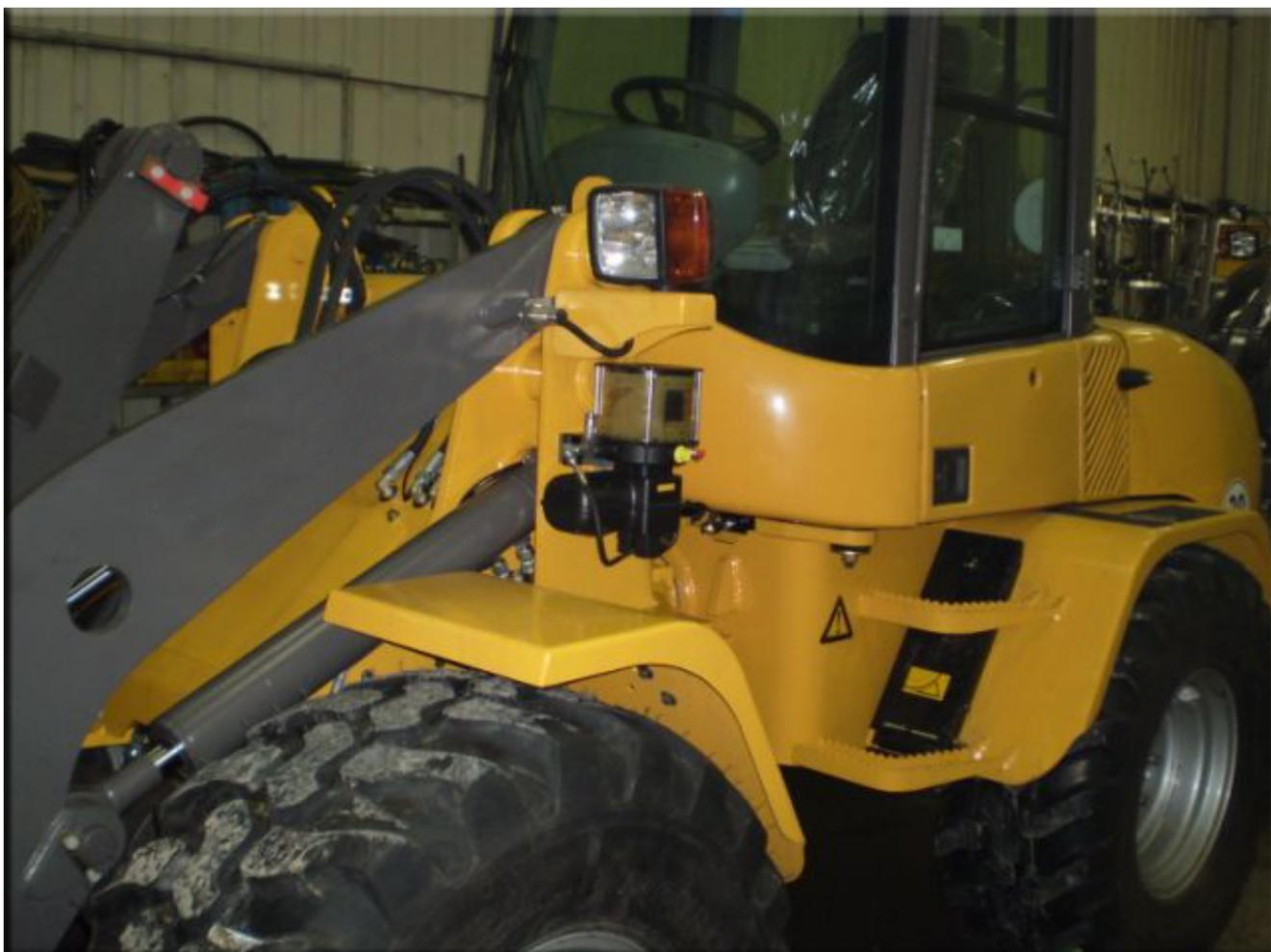
Sur cette **chargeuse montée sur roues**, on a installé une pompe ILC-MAX sur le pont de l'opérateur ou près de la cabine, pour la surveiller facilement.
