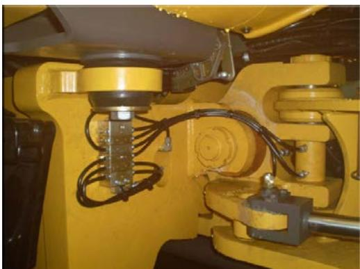
Les **répartiteurs progressifs** permettent au lubrifiant d'être distribué aux paliers, axes et bagues, qui en nécessitent de grandes quantités.
