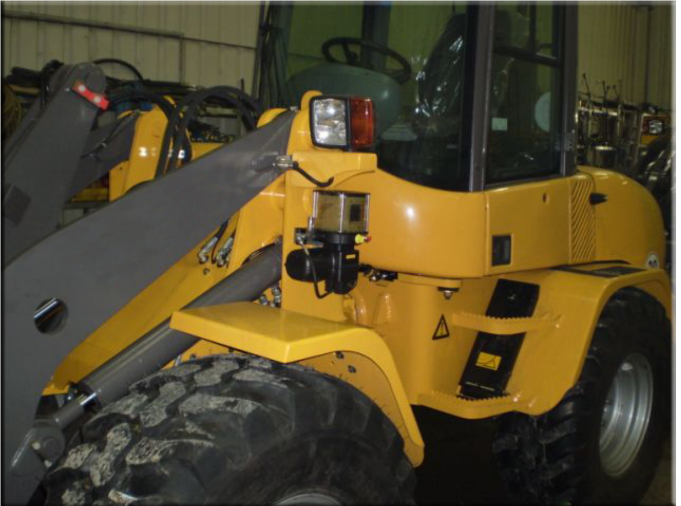
Auf diesem Radlader wird eine ILC-MAX-Pumpe zum Zwecke der einfachen Überwachung auf dem Bedienerdeck oder in der Nähe der Kabine montiert
