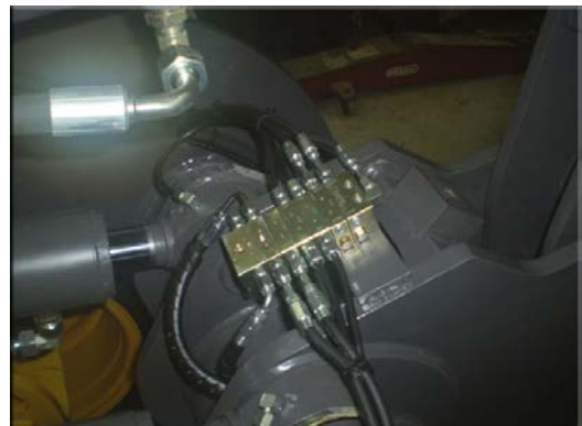
ILC-Verteiler ermöglichen bewiesenermaßen eine saubere und ordentliche Installation
