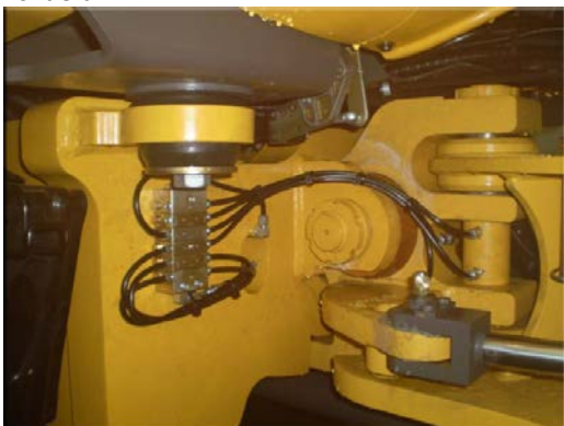
Durch Progressivverteiler wird sichergestellt, dass das Schmiermittel zu allen Verbrauchsschwerpunkt-Lagern, Bolzen und Buchsen befördert wird
