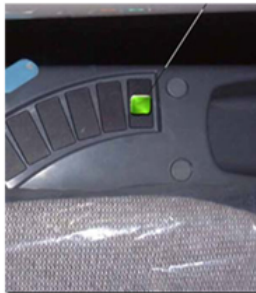
Optionaler Drucktaster mit Licht und Summer zur Alarmanzeige
