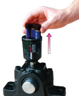
Retirer et remplacer le bloc de batteries
