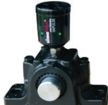
Contrôler et nettoyer le joint 1 IMPULSE reste sur le point de graissage
