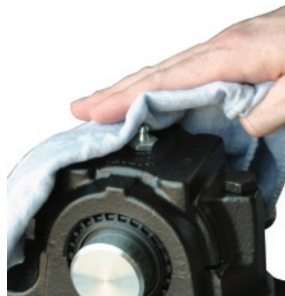
Nettoyage du point de graissage
