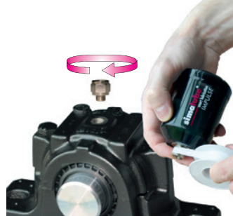
Reduceernippel inschroeven en smeerpunt afdichten
