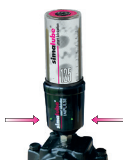
Apparaat wordt geactiveerd, groene LED knippert 2x ⚠ De eerste pompcyclus begint na 30 seconden
