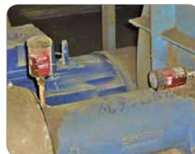
! Pour le pré-remplissage des pièces rapportées (cartouche de 400 g en p. 28), utilisez le même lubrifiant que dans le système de lubrification.
