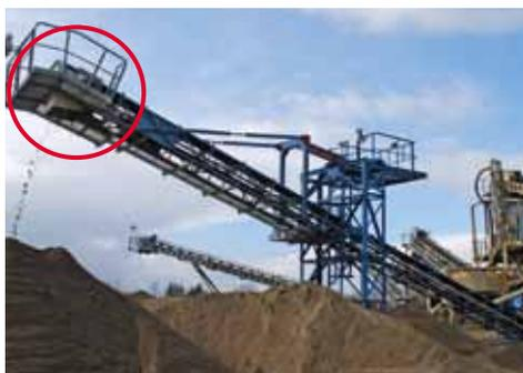
Les convoyeurs de grande taille sont souvent situés sur plusieurs niveaux et sont **difficilement accessibles**. Une lubrification idéale doit être effectuée sur l'installation en marche.
