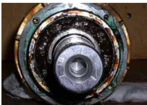
Lors d'une lubrification manuelle, la quantité de graisse dispensée est **dosée de manière irrégulière**. Une quantité importante de lubrifiant est alimentée en une seule fois. Ceci entraîne une **lubrification excessive du roulement** à court terme. Les intervalles de lubrification ne sont pas respectés, engendre une **lubrification insuffisante**.
