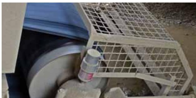
Lors d'un montage déporté, la longueur de la tuyauterie souple doit être adaptée aux exigences du lubrifiant, du système de lubrification et de l'environnement.
