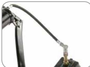
Pré-graisser le point de lubrification et les pièces de raccordement, éventuellement pré-remplir au préalable le flexible (utiliser le même lubrifiant que dans le système de lubrification)
