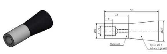
**Pinsel Ø30 mit Halterung und Steckanschluss gerade**
