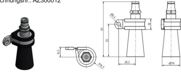
**Pinsel Ø30 mit Halterung und Steckanschluss 90°**
