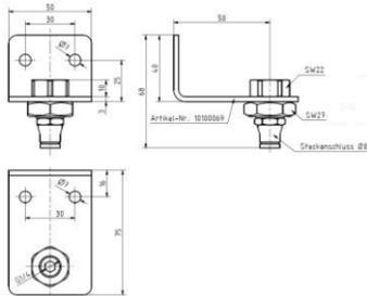
**Haltwinkel Steckanschluss Ø8 90°**
