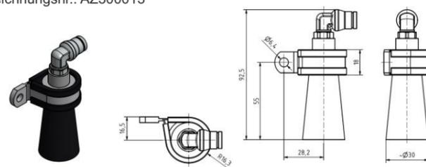
**Pinsel Ø20 mit Halterung und Steckanschluss gerade**
