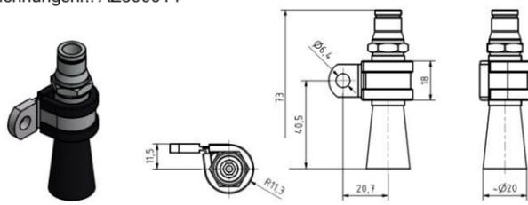
**Pinsel Ø20 mit Halterung und Steckanschluss 90°**
